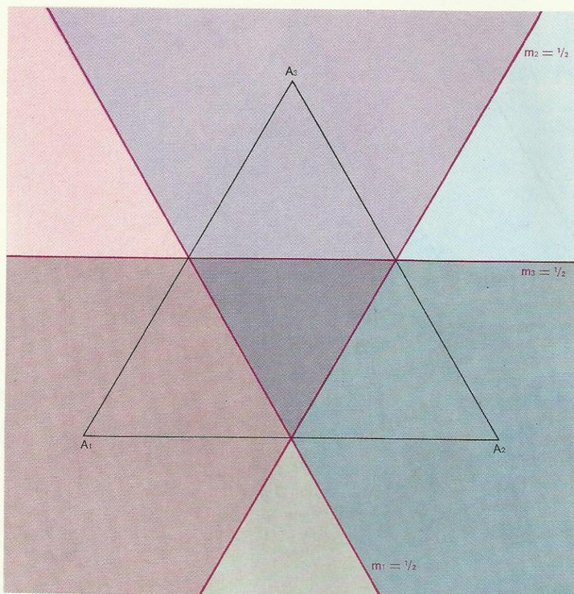
Il problema di determinare la probabilità che una bacchetta di materiale fragile si rompa in tre pezzi di lunghezza tale che con essi si possa costruire un triangolo dà luogo a tre disequazioni e a tre semipiani. Nel triangolo baricentrico questi delimitano un triangolo più piccolo (al centro, in colore più intenso) che racchiude i « casi favorevoli »; la probabilità è  $1/4$  poiché il triangolo ottenuto è pari a  $1/4$  del triangolo di partenza.
