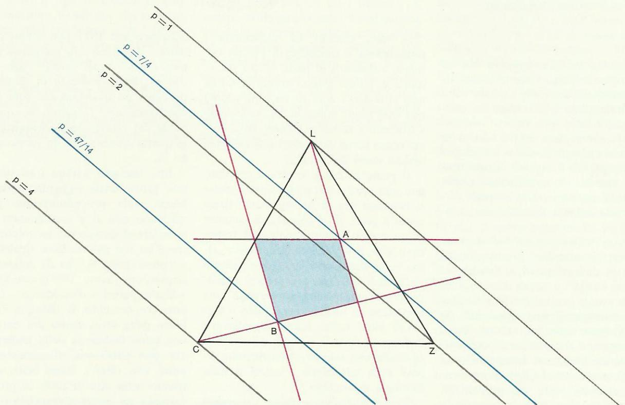
Applicazione del calcolo baricentrico alla programmazione della fabbricazione di cioccolata i cui componenti si trovano ai vertici di un triangolo. Le condizioni a cui deve soddisfare il prodotto sono rappresentate da quattro disequazioni e cioè da quat-
