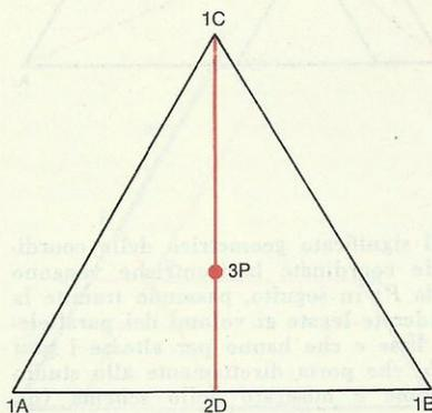
Triangolo « senza peso » impiegato per illustrare il calcolo baricentrico nel piano. Il triangolo consente la composizione di tre pesi, per cui a ogni punto del triangolo viene a corrispondere una terna di coordinate baricentriche. Nel caso in cui i tre pesi applicati ai vertici sono tutti uguali, il baricentro del triangolo risulta essere proprio il centro geometrico di figura (schema a sinistra).
